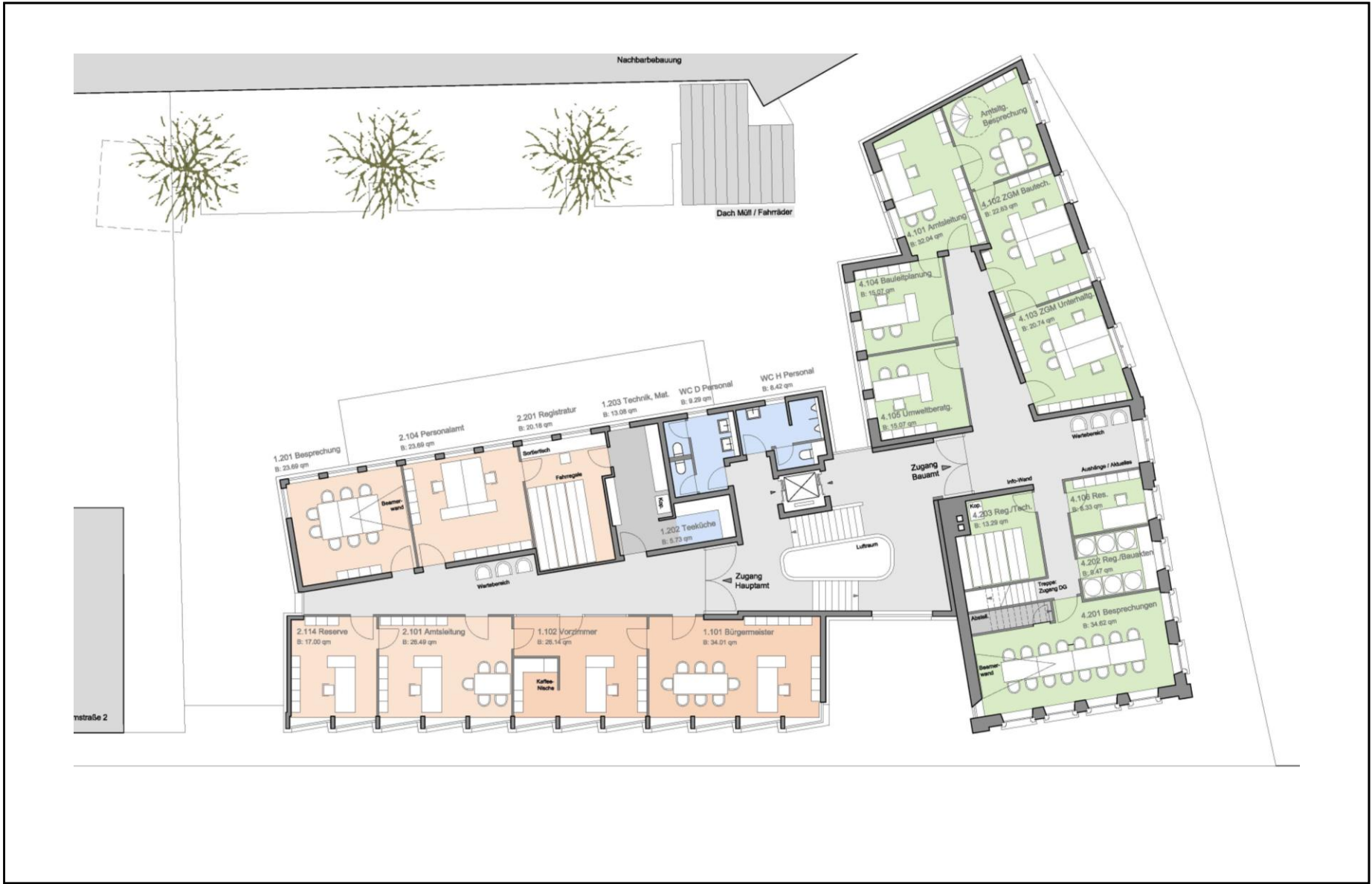
Grundriss OG_ Umbau und neuer Anbau
